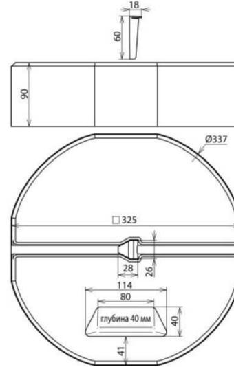
Бетонные опоры для молниеприемников, для защиты небольших сооружений на плоских кровлях и для монтажа дистанционных держателей, например, изолированных кольцевых проводников, или для отдельно стоящих молниеприемников на треногах.
