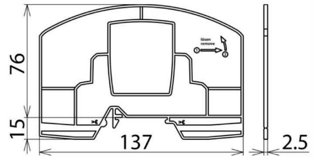
Размерный эскиз разделительной перегородки
