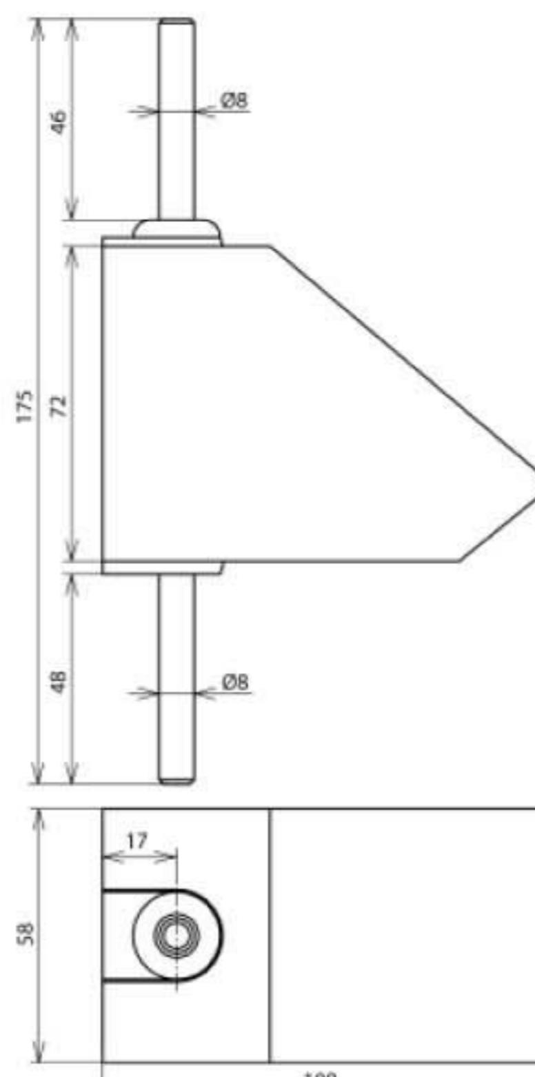
Счетчик для цифровой регистрации импульсных токов, вызванных разрядами молнии.
