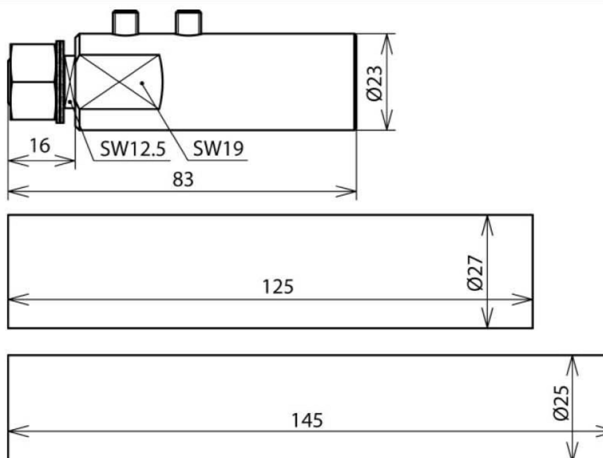
Установочный набор для соединения токоотвода HVI-long в зоне концевой заделки токоотвода с металлической трубостойкой снаружи с помощью насадки (верхняя часть для соединительной пластины). Вкл. 2 термоусадочную трубку и 2 кабельных стяжки.
