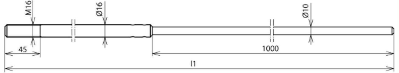
Стержневой молниеприемник с уменьшением диаметра (1000 мм) с резьбой M16, для защиты сооружений на кровле, каминов и т.п., для монтажа в бетонную опору (17 кг) с резьбовым переходником.
