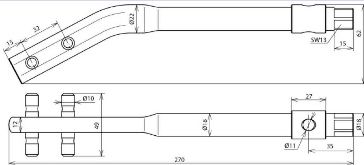
с размерами под ключ (SW13) для закручивания
