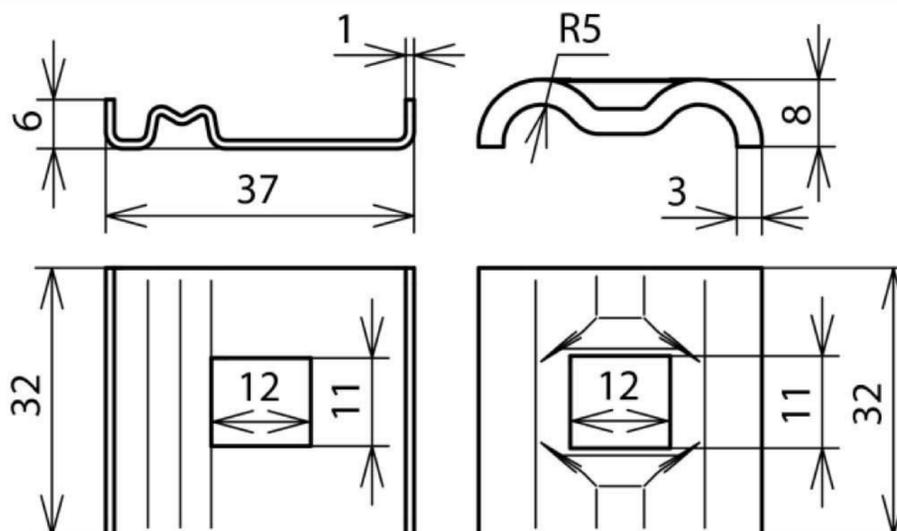
Заземляющие клеммы для соединения монтажных элементов, например, фотогальванических установок, в системах функционального уравнивания потенциалов / функционального заземления (цвет проводника черный) и молниезащитного уравнивания потенциалов согласно стандарту DIN EN 62305-3 (VDE 0185-305-3)
