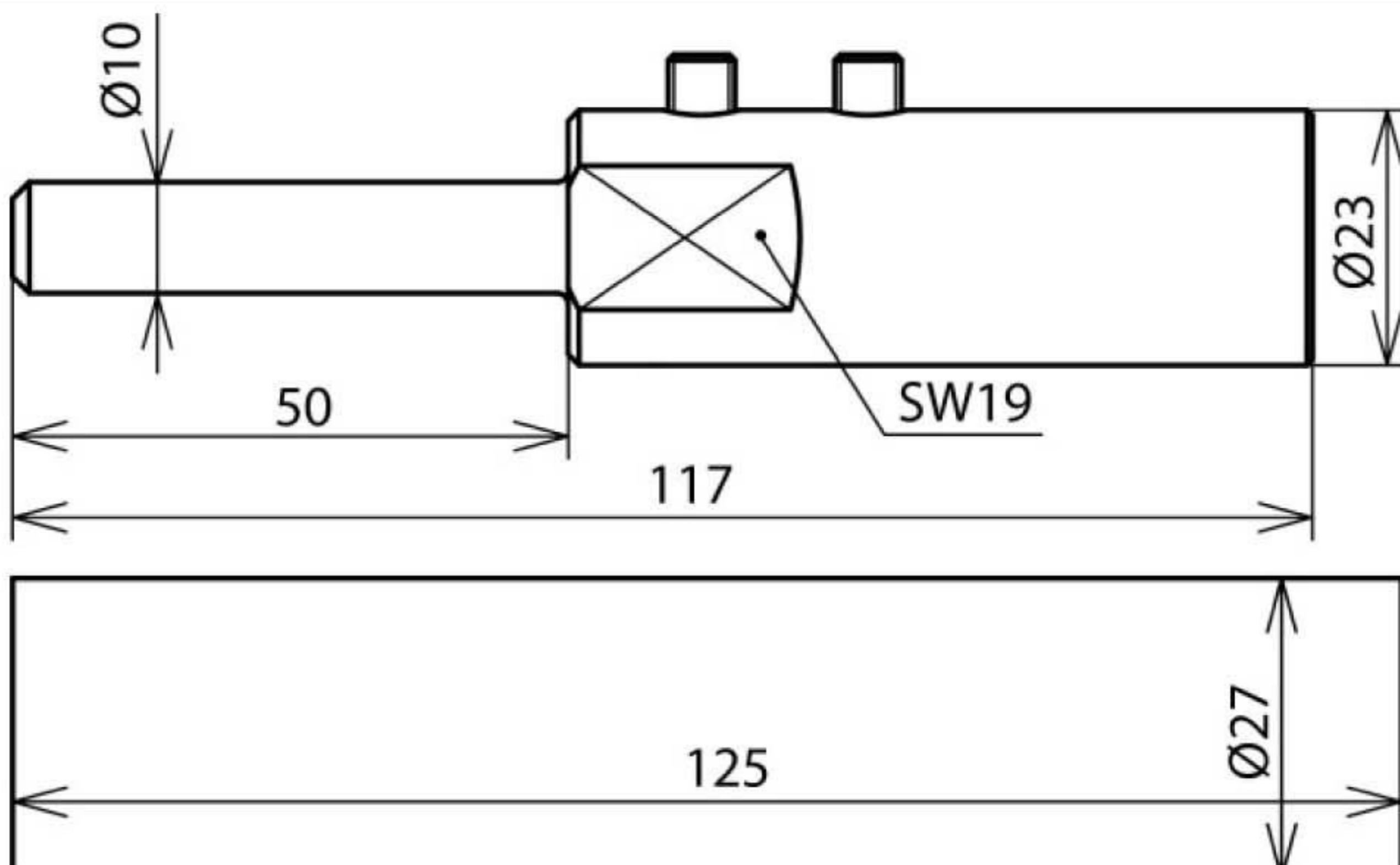
Установочный набор для соединения токоотвода HVI-long в зоне концевой заделки токоотвода с металлической трубостойкой снаружи с помощью насадки (верхняя часть для соединительной пластины). Вкл. 1 термоусадочную трубку и 2 кабельных стяжки.
