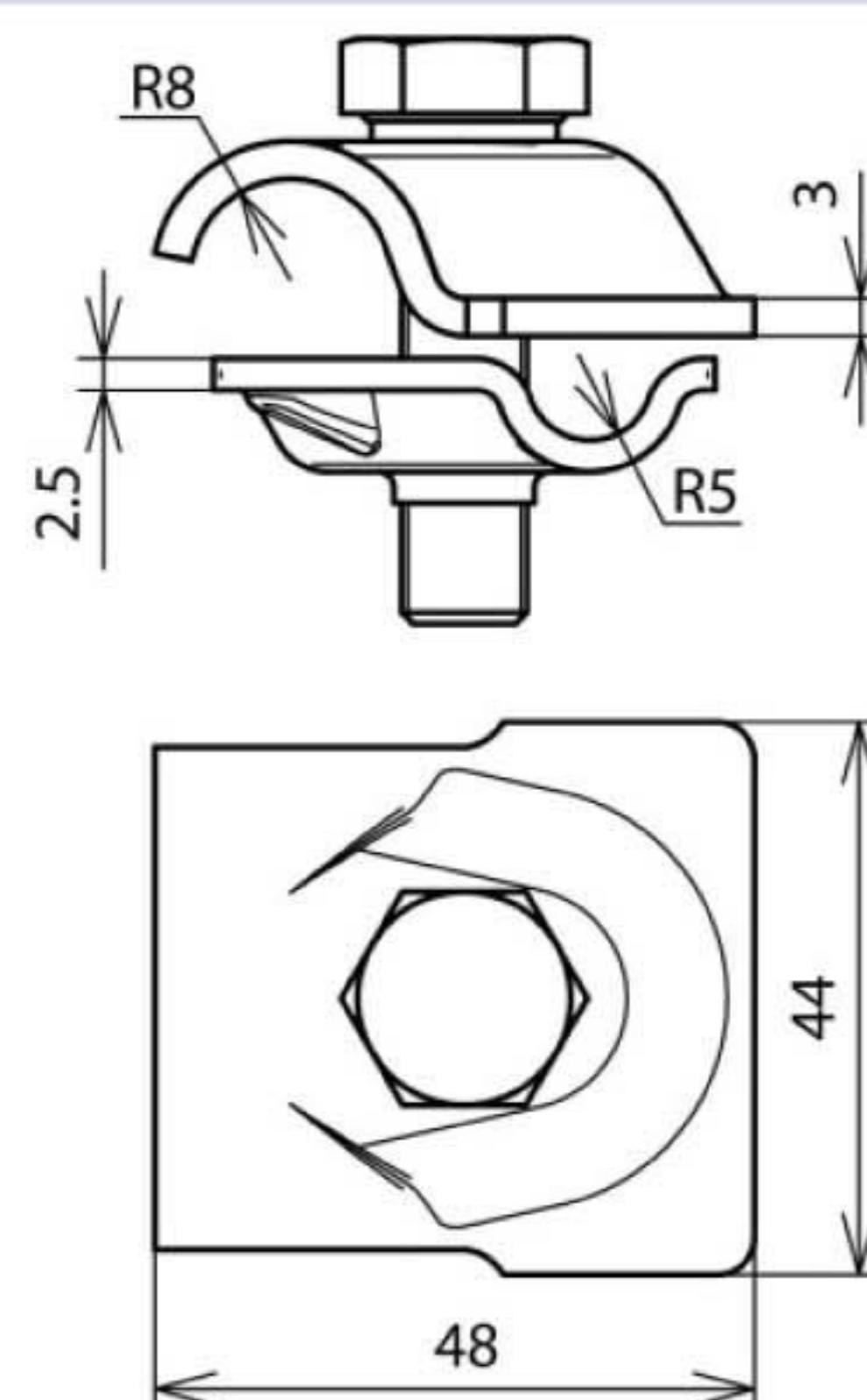
Универсальные соединительные клеммы, состоящие из двух частей, для использования в качестве крестообразных, Т-образных или параллельных клемм. Способность выдерживать токи молнии до 200 кА (10/350 мкс).
