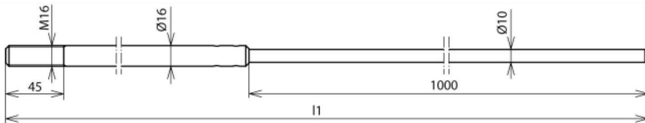
Стержневой молниеприемник с уменьшением диаметра (1000 мм) с резьбой M16, для защиты сооружений на кровле, каминов и т.п., для монтажа в бетонную опору (17 кг) с резьбовым переходником.
